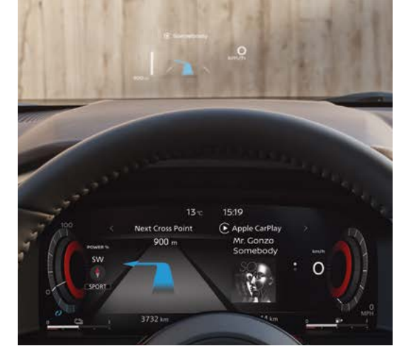
12,3" dijital gösterge paneli 10,8" ön cama yansıtılmalı renkli bilgi ekranı (head-up)
